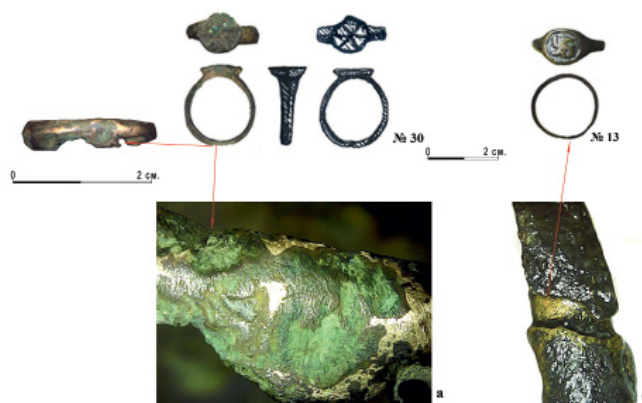
Рис. 2. Перстень литой: а – микрофотографии литейного шва на дужке перстня; б – дендритная структура (увеличение в 100 х ) (стрелкой указано место съемки)
